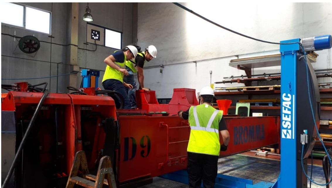
Figura 16. Mantenimiento de un spreader
