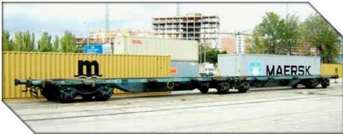
Ilustración 25: Fotografía vagón tipo MMMC1. Fuente: http://www.renfe.com/empresa/mercancias/intermodal/vagones_mmc1
