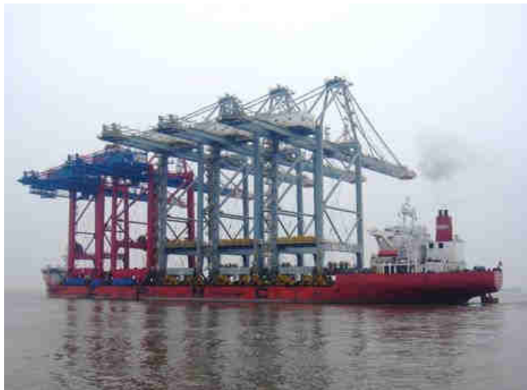
Imagen 15: Transporte de grúas pórtico
