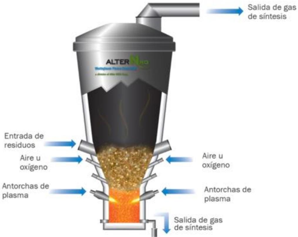
Figura 21: Tanque de gasificación por plasma.
