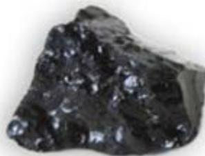
*Figura 24: Slag enfriado al aire.*
