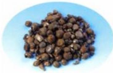
*Figura 23: Nódulos metálicos separados de arena.*
