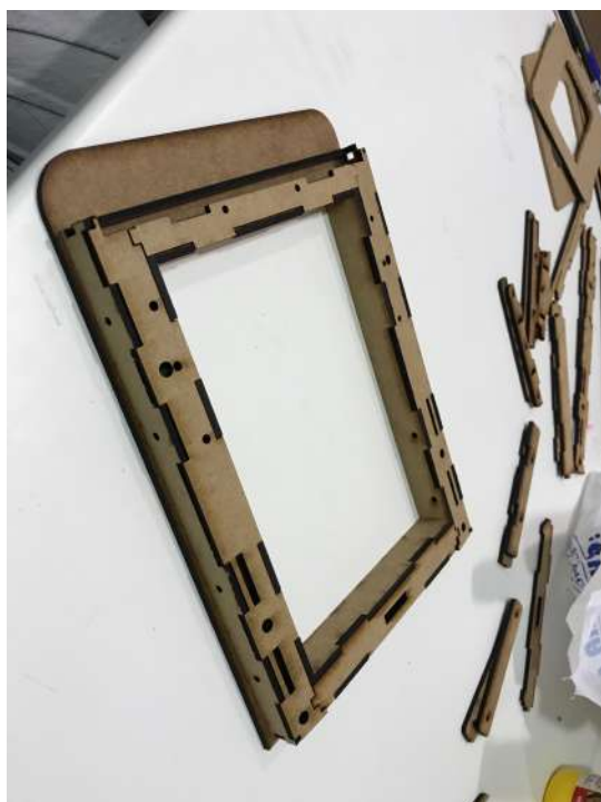
(a) Montaje del marco de madera
