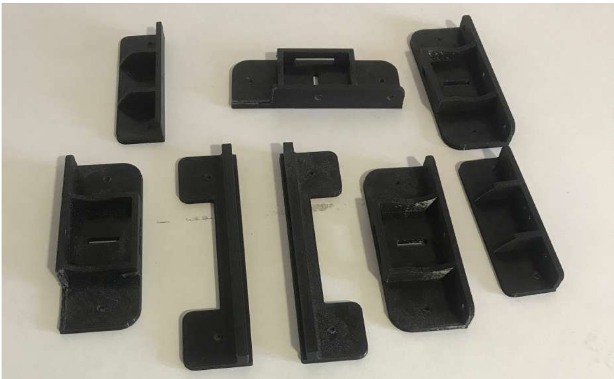
Figura 4.15. Piezas impresas en ABS.
