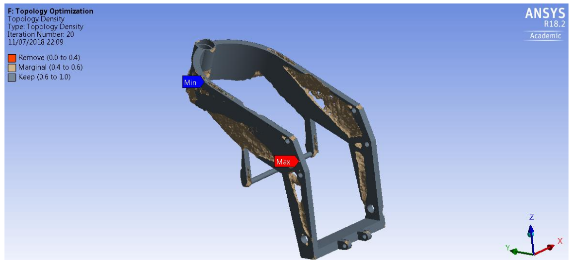
Figura 4. 28: Optimización Topológica (chasis curvo - prueba estática)
