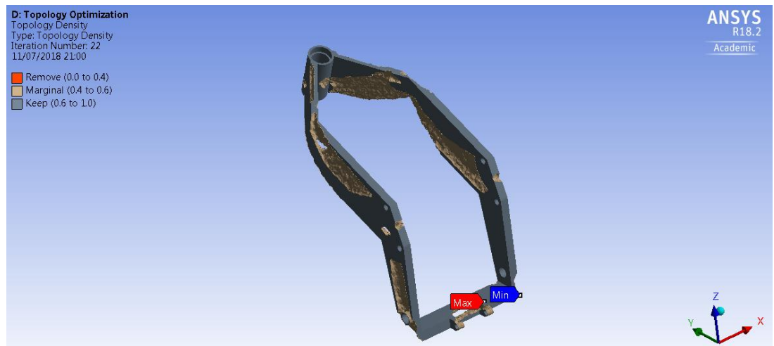
Figura 4. 10: Optimización Topológica (chasis recto - ensayo matricial)
