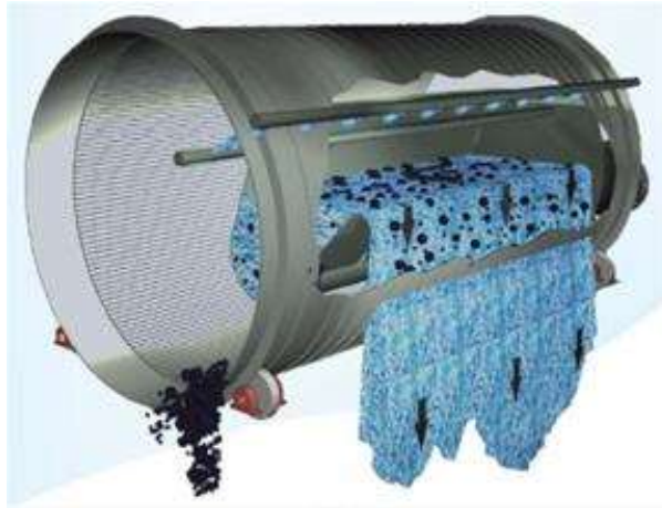
Figura 9: Tamiz Rotativo Mostrando flujo de Agua.
