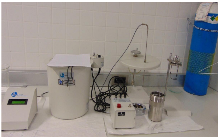
Figura 13. Bomba calorimétrica de laboratorio empleada en la determinación del PC.
