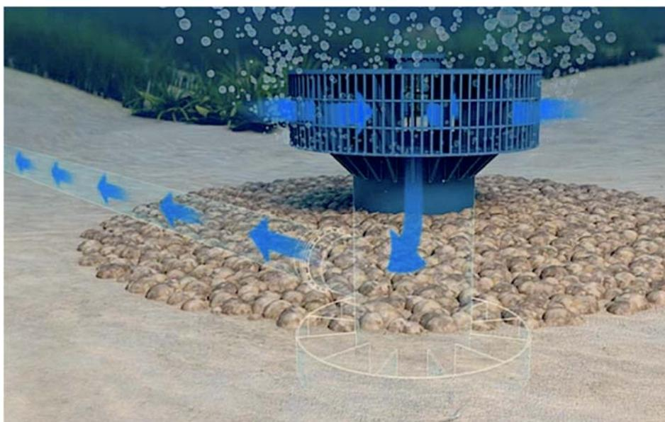
*Figura 20: Torre de toma para el abastecimiento de la planta desalinizadora.*
