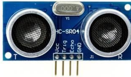
Figura 7: sensor ultrasonidos HC-SR04
