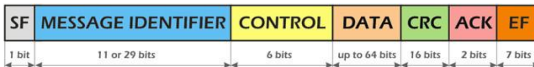
Figura 2 - Esquema de los campos del protocolo CAN [6]
