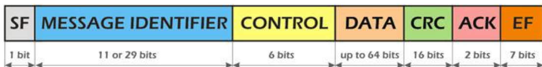
Ilustración 2 - Esquema de los campos del protocolo CAN [8]
