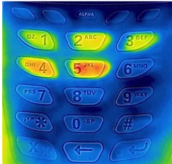
Figura 15 cámara térmica en teclado numérico
