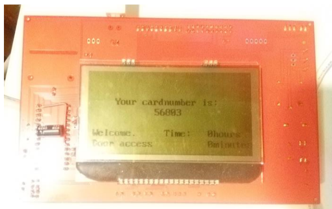
Figura 23 Mensaje de bienvenida y de acceso a la puerta
