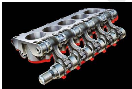
FIGURA 2: CULATA MÓVIL DEL SVC [16]
