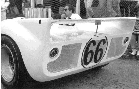
Ilustración 3-24 - Alerón trasero del Chaparral 2C [24]
