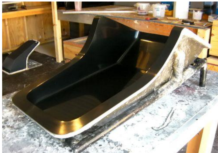
Ilustración 6-8 - Ejemplo molde terminado de fibra de vidrio [34]
