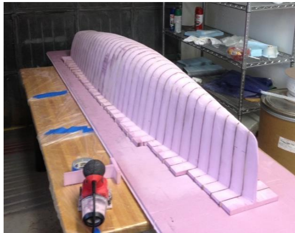
Ilustración 6-7 - Ejemplo de modelo creado con espuma [33]
