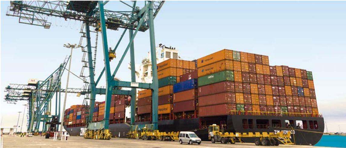
Figura 28. Mafis en operación de descarga de buque.
