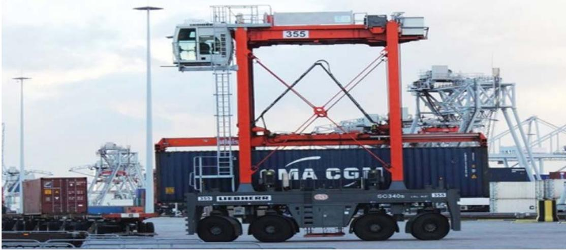
Figura 24. Straddle carrier en ECT Rotterdam.
