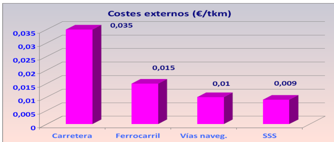
Gráfico con el coste de cada tipo de transporte. Fuente: Escola Europea del Short Sea Shipping
