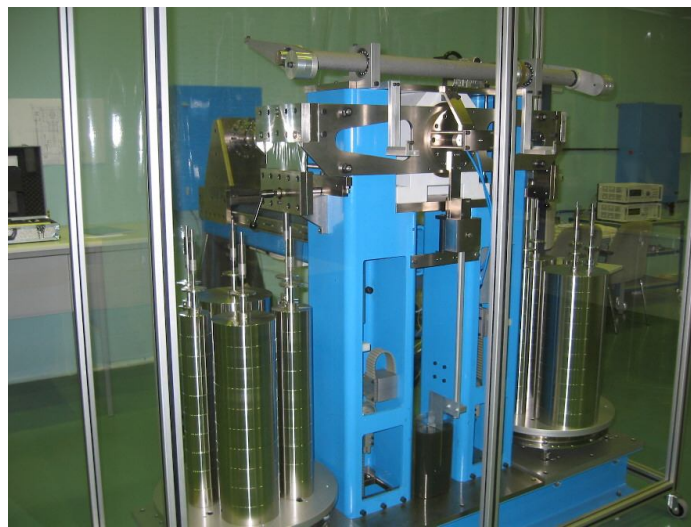
Figura 6: Máquina patrón de par de carga directa en el CEM (J. A. Robles, J. L. Robles & Lobo, 2006)
