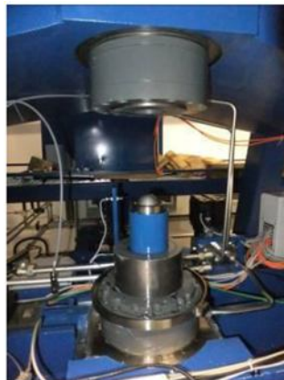
Figura 3: Ejemplo del sistema de hidráulico en la base de una máquina patrón de amplificación hidráulica en el BEV (Buchner et al., 2012)
