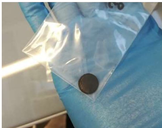
(fig. 32): muestra de condensador experimental para mediciones del dieléctrico
