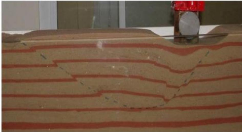
Ilustración 31: Ejemplo real de cuando un suelo falla a cortante [LEON87]
