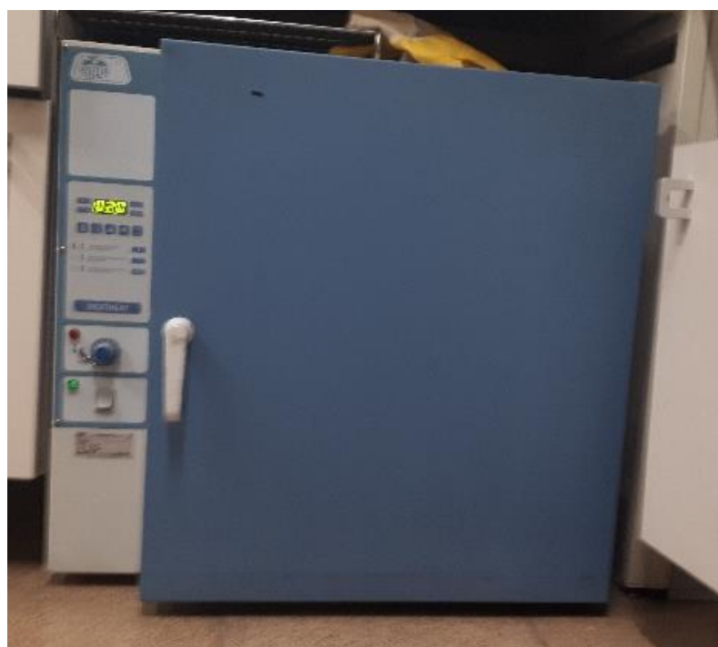
Imagen 15: estufa JP Selecta de 230V/ 50-60Hz/ 1200W.
