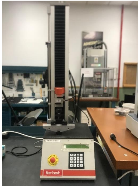
Imagen 17: máquina universal Ibertest IBTH-5/500
