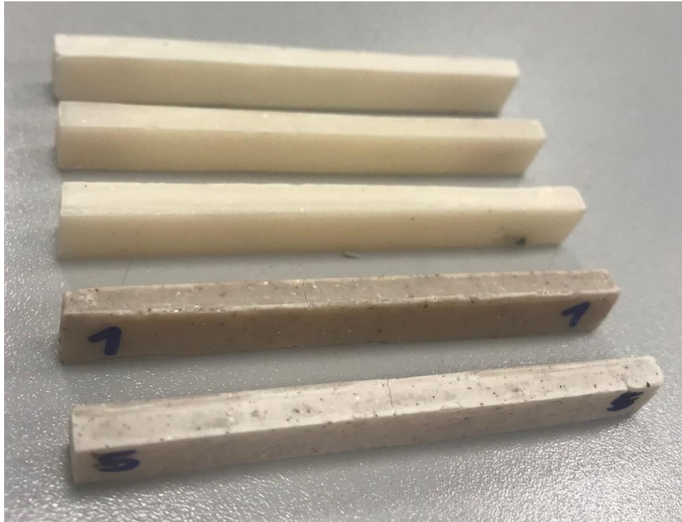
Imagen 13: probetas de flexión terminadas de (arriba abajo) cemento blanco, con vancomicina, con gentamicina, con microcápsulas de rifampicina y con la mezcla de los tres antibióticos.
