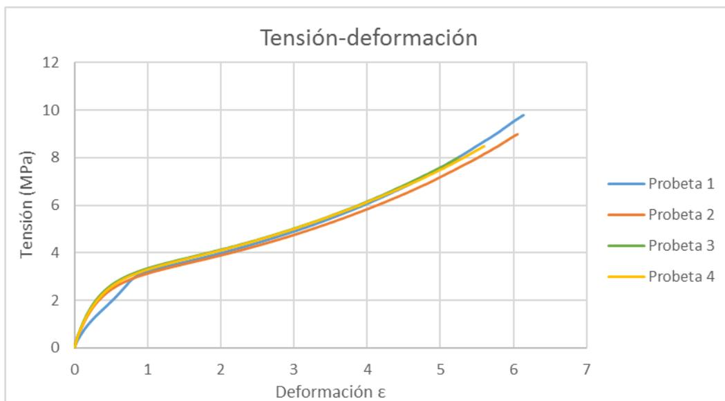
Figura 83. Ensayo de tracci3n TPE 20% de relleno tras 24h de envejecimiento en gasolina 98
