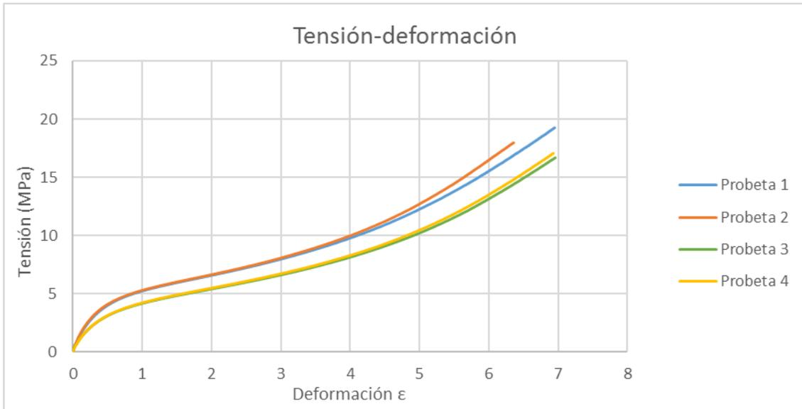
Figura 92. Ensayo de tracci3n TPE 80% de relleno tras 1 semana de envejecimiento en gasolina 98
