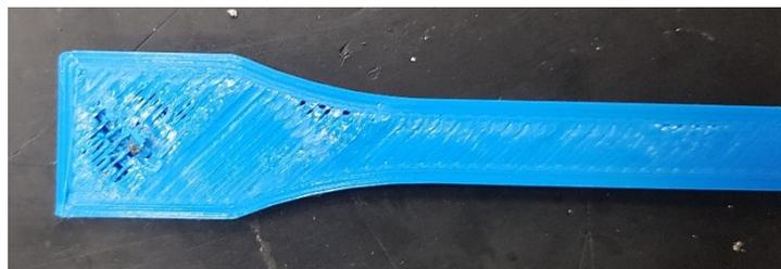
Figura 53. Detalle de la superficie de probeta TPU con un 5% de relleno
