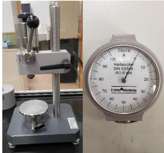
Figura 36. Equipo para medición de dureza Shore A
