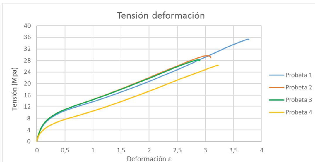
Figura 71. Ensayo de tracción TPU 50% relleno tras 24h de envejecimiento en gasolina 98
