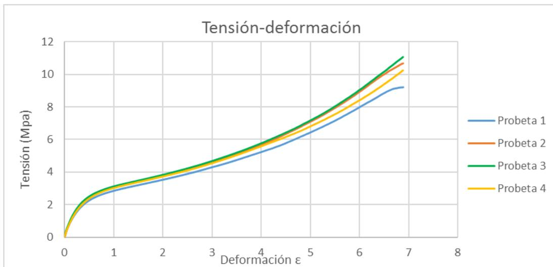
Figura 79. Ensayo de tracción TPE 5% de relleno tras 24h de envejecimiento en gasolina 98
