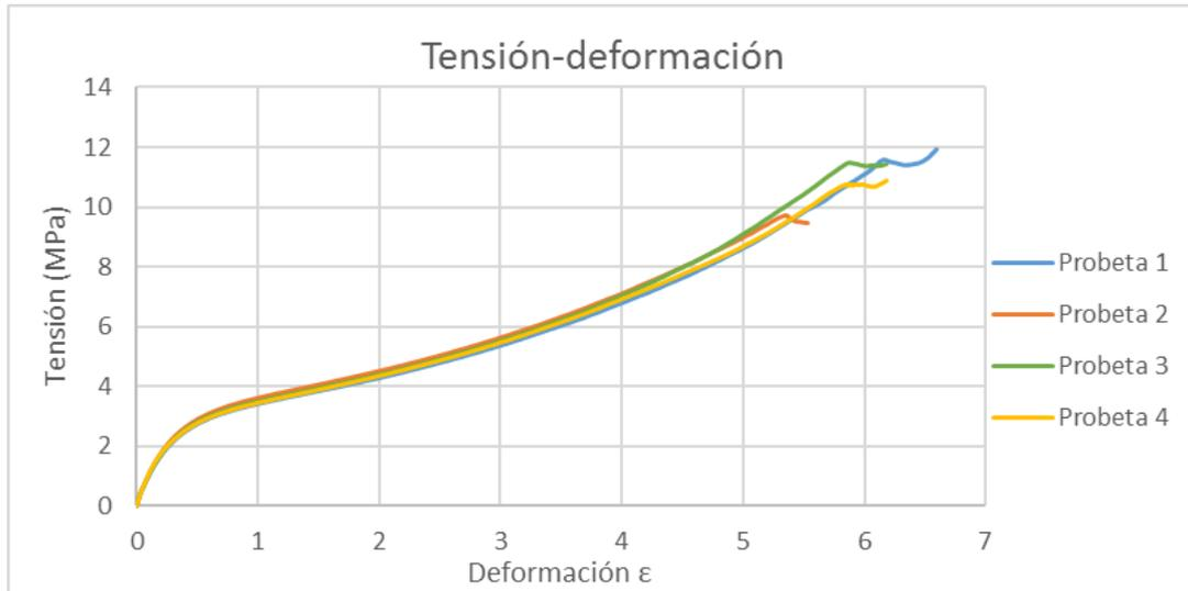
Figura 82. Ensayo de tracci3n TPE 20% de relleno sin envejecimiento
