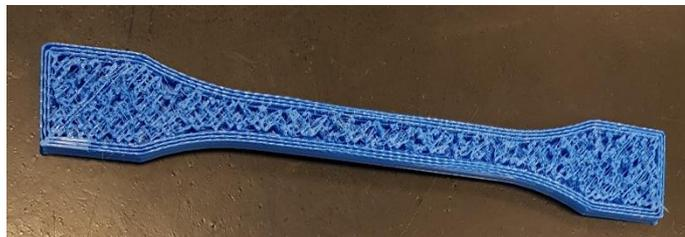
Figura 30. Defectos en la impresión en DYNAMICAL TOOLS DT600
