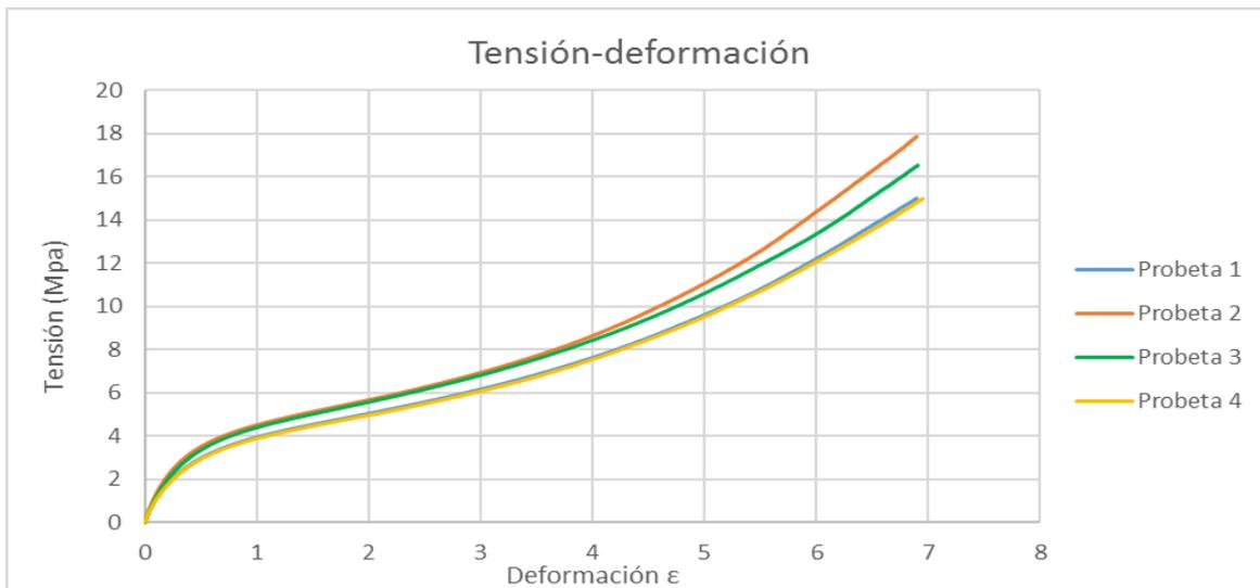
Figura 88. Ensayo de tracci3n TPE 50% de relleno tras 1 semana de envejecimiento en gasolina 98
