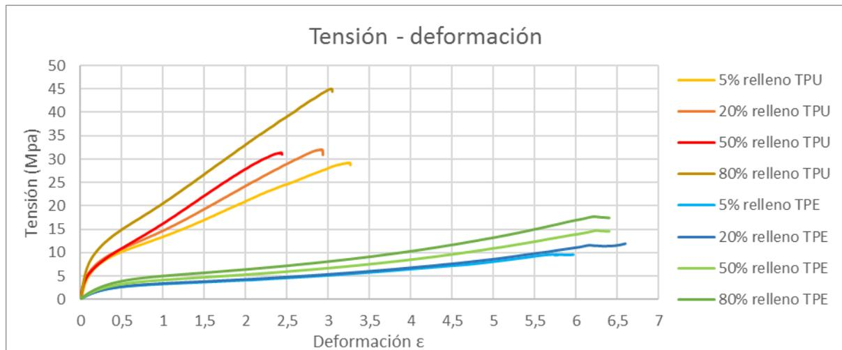
Figura 51. Ensayo de tracción TPU y TPE en condiciones estándar
