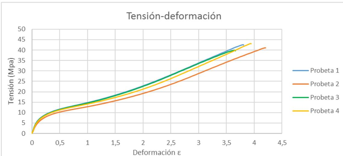
Figura 76. Ensayo de tracción TPU 80% de relleno tras 1 semana de envejecimiento en gasolina 98
