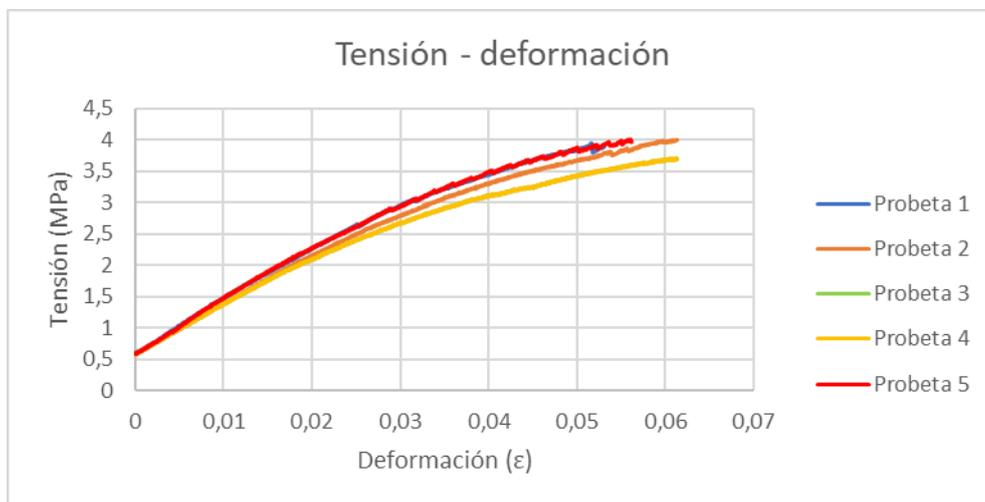
Figura 100. Ensayo de flexión TPU 20% de relleno tras 1 semana de envejecimiento en gasolina 98
