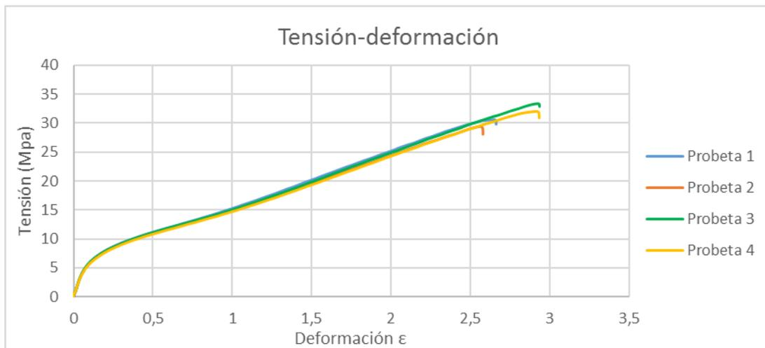
Figura 66. Ensayo de tracción TPU 20% de relleno sin envejecimiento
