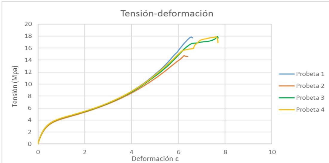
Figura 86. Ensayo de tracci3n TPE 50% de relleno sin envejecimiento
