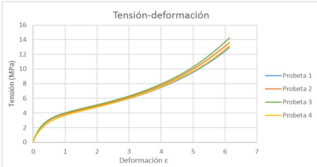
Figura 84. Ensayo de tracci3n TPE 20% de relleno tras 1 semana de envejecimiento en gasolina 98
