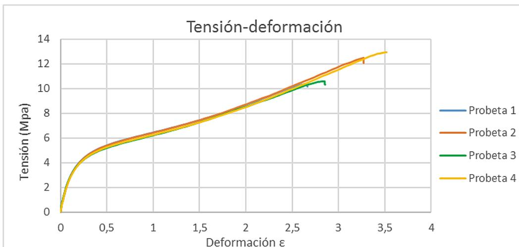
Figura 63. Ensayo de tracción TPU 5% de relleno tras 24h de envejecimiento en gasolina 98
