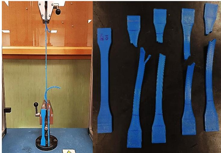
Figura 39. Deformación de las probetas durante el ensayo y tras rotura
