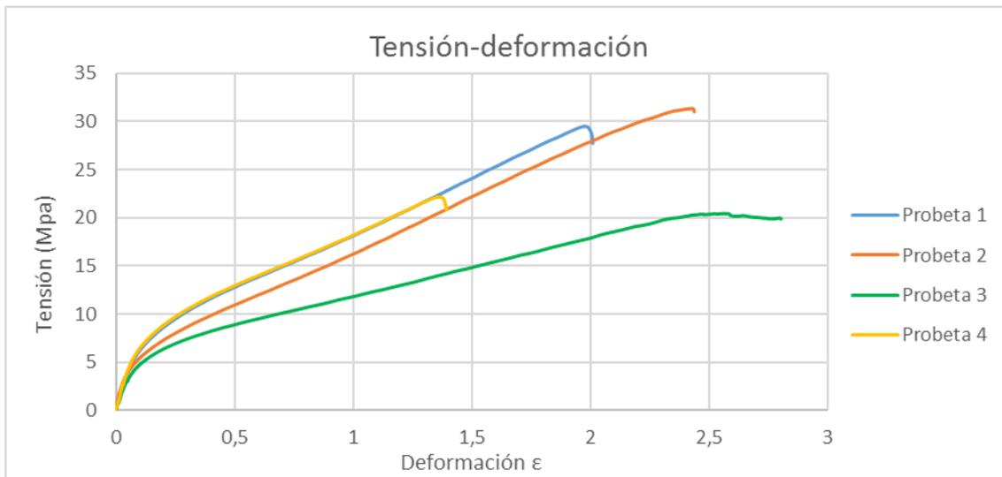
Figura 70. Ensayo de tracción TPU 50% de relleno sin envejecimiento
