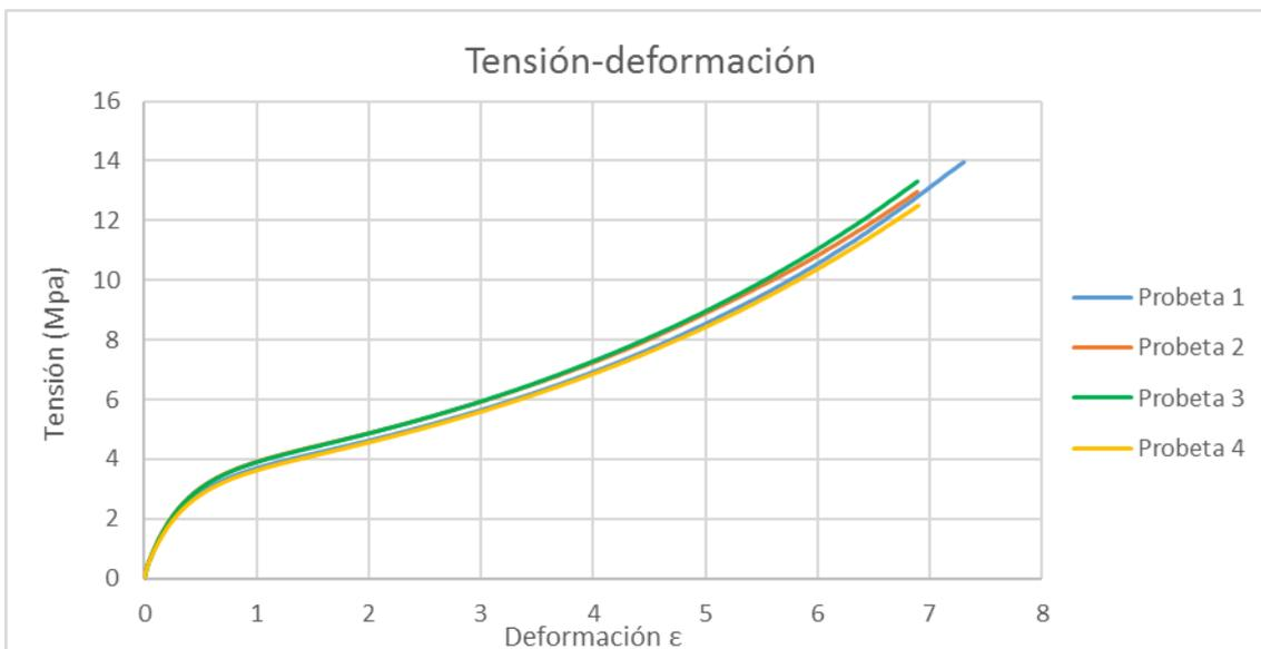
Figura 87. Ensayo de tracci3n TPE 50% de relleno tras 24h de envejecimiento en gasolina 98
