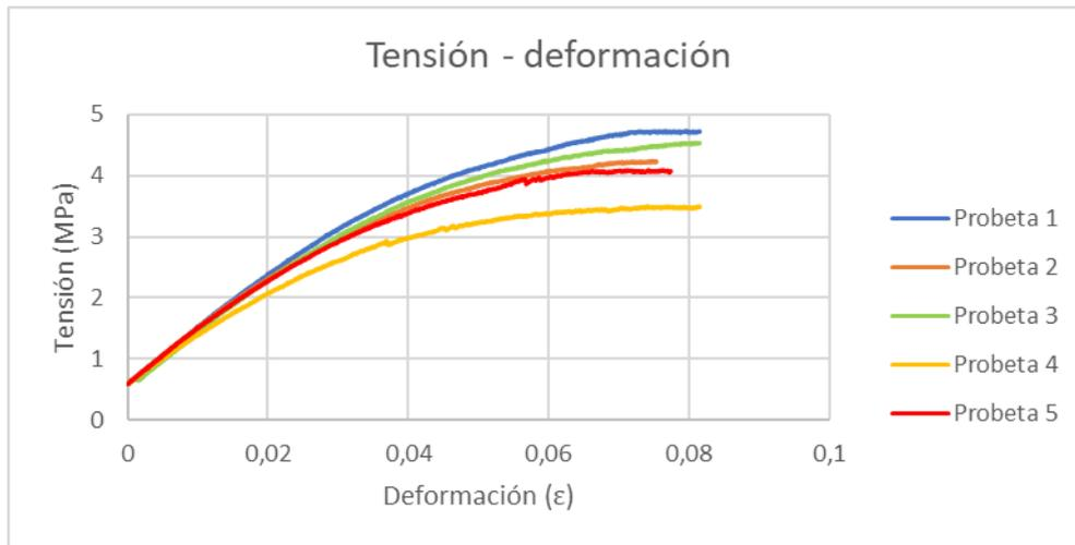
Figura 101. Ensayo de flexión TPU 20% de relleno tras 1 mes de envejecimiento en gasolina 98
