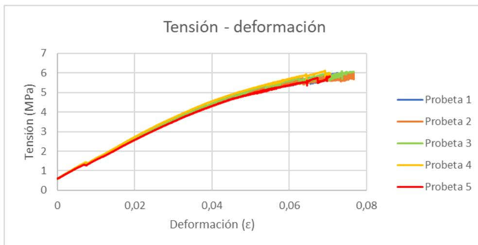
Figura 94. Ensayo de flexión TPU 5% de relleno sin envejecimiento
