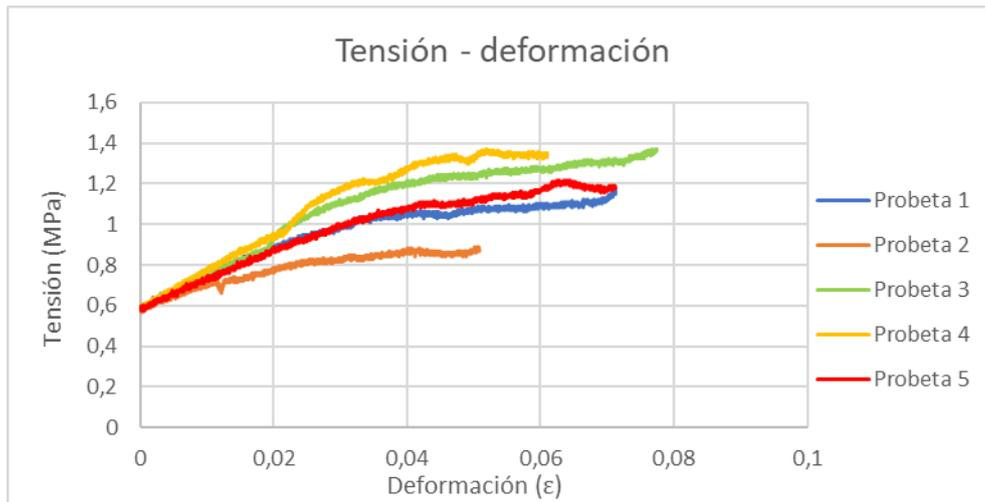
Figura 113. Ensayo de flexión TPE 5% de relleno tras 1 mes de envejecimiento en gasolina 98
