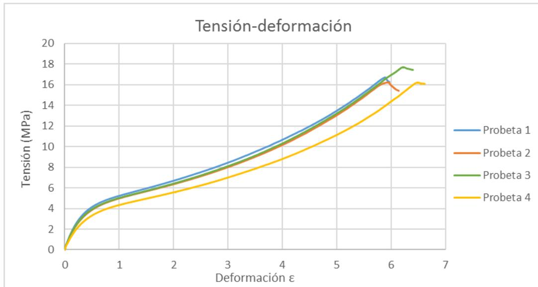
Figura 90. Ensayo de tracci3n TPE 80% de relleno sin envejecimiento
