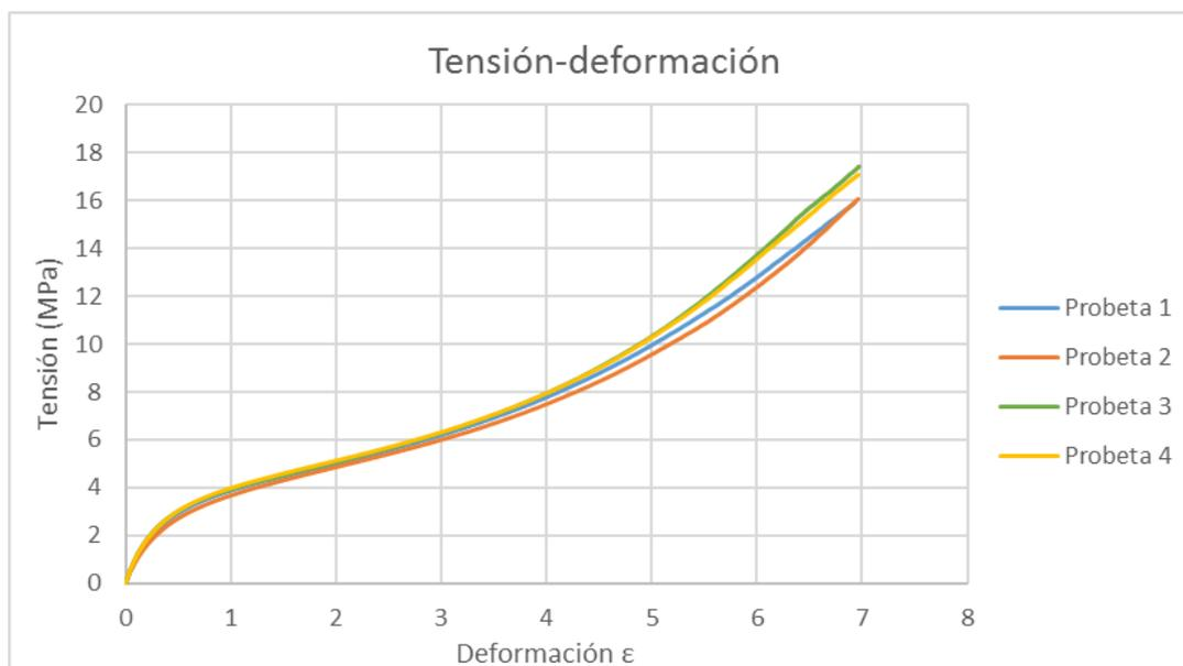
Figura 85. Ensayo de tracci3n TPE 20% de relleno tras 1 mes de envejecimiento en gasolina 98
