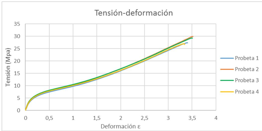
Figura 68. Ensayo de tracción TPU 20% de relleno tras 1 semana de envejecimiento en gasolina 98
