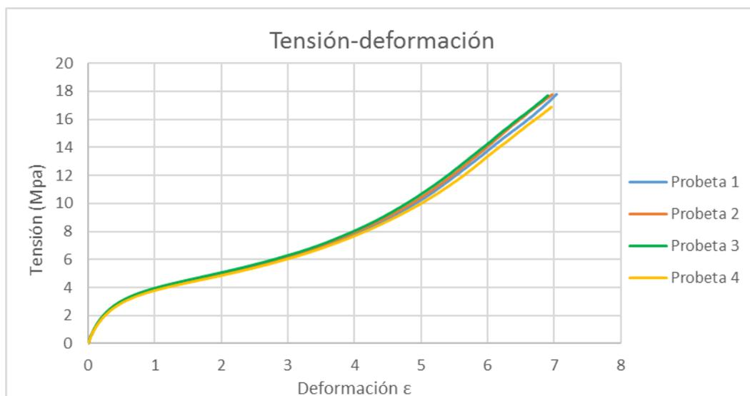
Figura 81. Ensayo de tracci3n TPE 5% de relleno tras 1 mes de envejecimiento en gasolina 98
