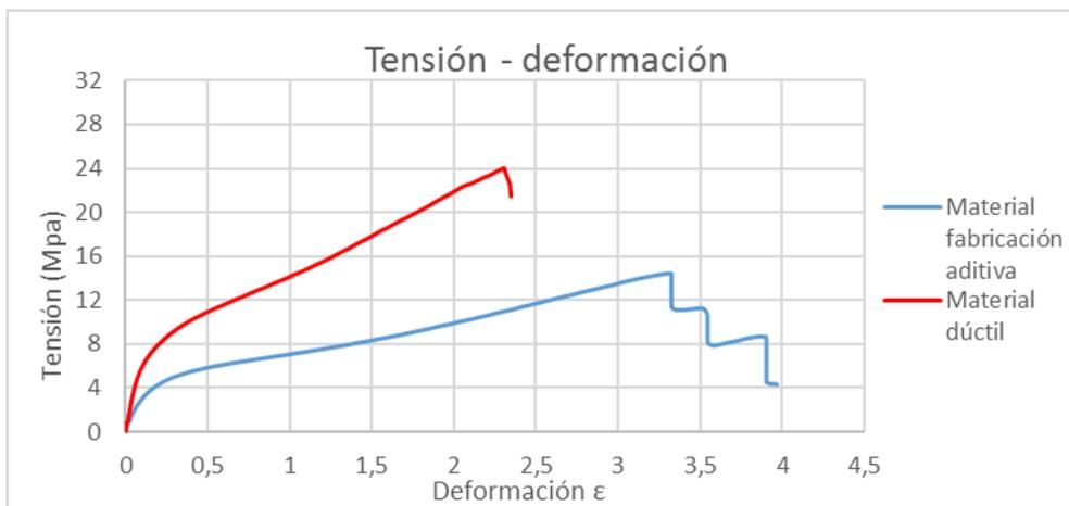
Figura 49. Comportamiento de probetas por fabricación aditiva frente a un material dúctil
