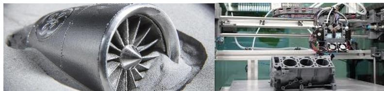
Figura 4. Fabricación aditiva de piezas complejas
