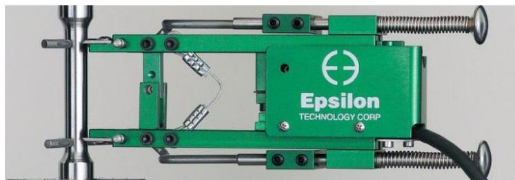
Figura 40. Extensómetro 3542-050M-050-ST
