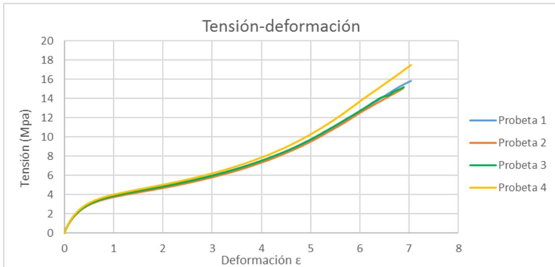
Figura 80. Ensayo de tracci3n TPE 5% de relleno tras 1 semana de envejecimiento en gasolina 98
