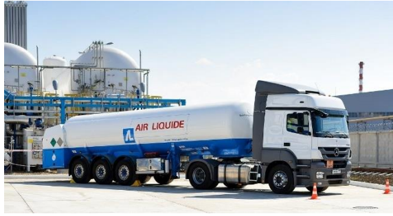
Figura 13. Camión cisterna para el transporte de hidrógeno líquido.
