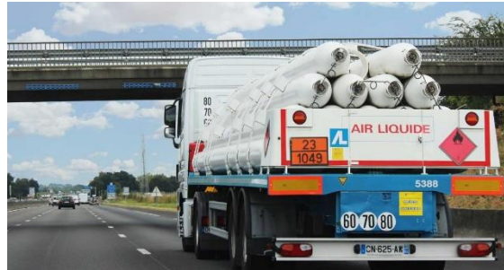
Figura 12. Camión con remolque de botellas presurizadas para el transporte de H 2 en estado gaseoso.
