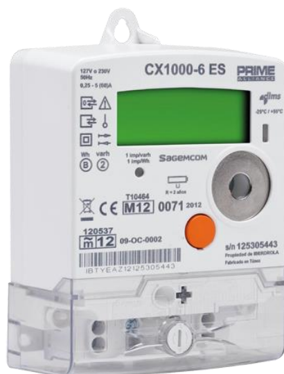
Ilustración 4. Contador inteligente de la marca PRIME.
