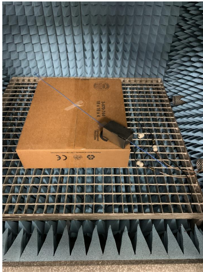
Ilustración 22. Satélite dentro cámara anecoica para realizar las medidas
