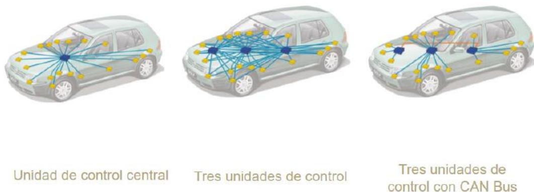
Figura 13. Aplicación del CAN bus en los coches. [10]
