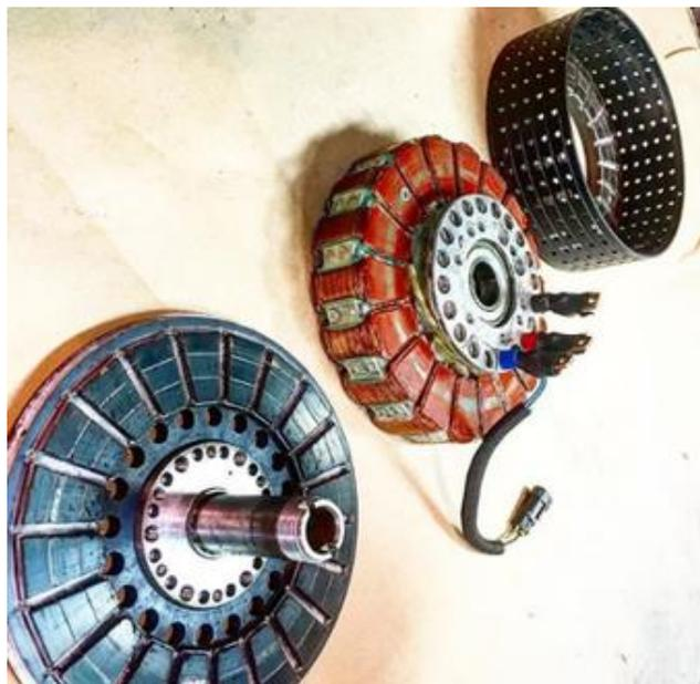
Figura 6. Motor EMRAX despiezado. [23]
