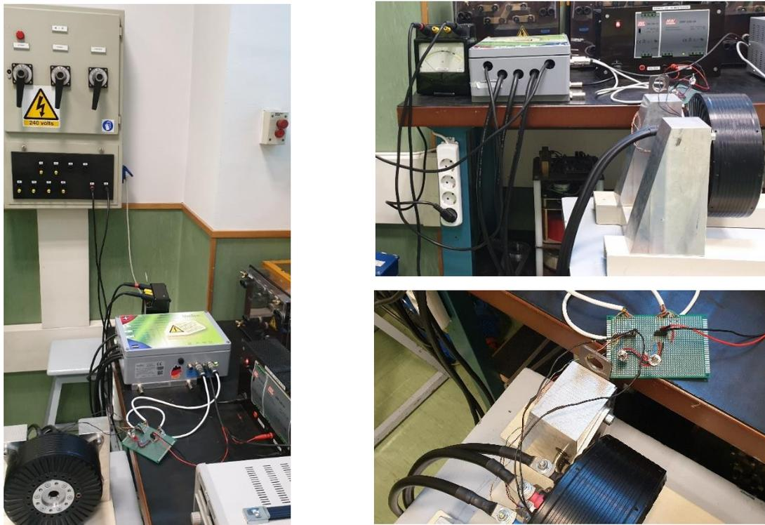
*Figura 37. A la izquierda, vista general de la bancada con la tensión de continua en la pared. Arriba a la derecha se ven claramente los aparatos involucrados en el ensayo. Abajo, vista de la placa provisional con los interruptores 'Enable'.*
