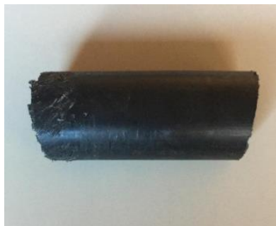
Ilustración 56: Perfil de tubería de polietileno
