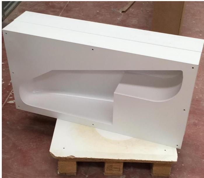
**FIGURA 5-5: MITAD DEL MOLDE DEL CARENADO**
