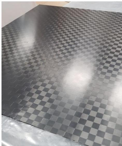
**FIGURA 5-1: PLANCHA DE FIBRA DE CARBONO**
