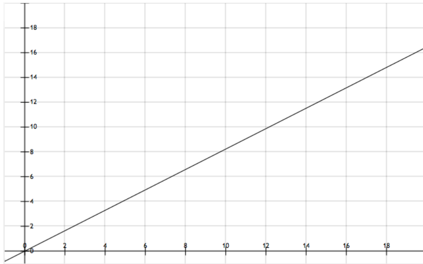
Figura 6: Relación de compresión efectiva tras la modificación en función de la antigua relación de compresión
