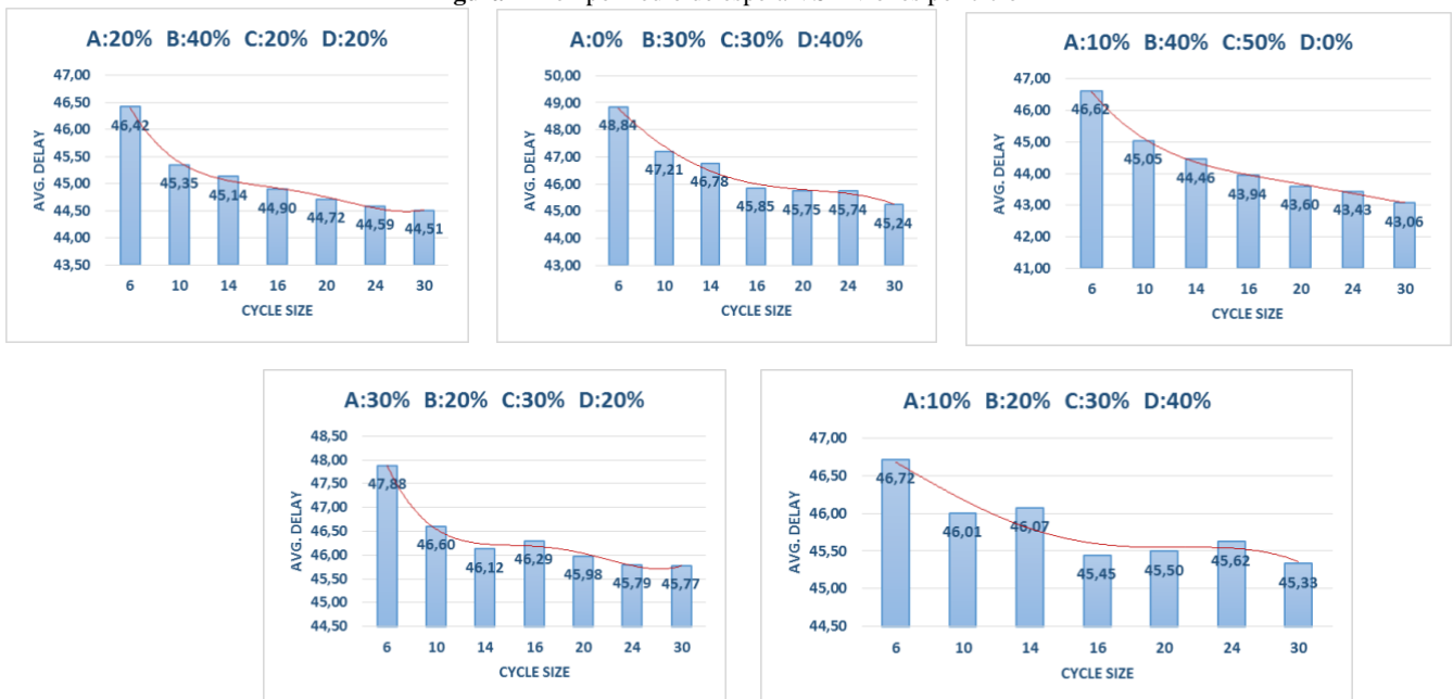
Figura 8 Análisis individual tiempos de espera medios VS Aviones por ciclo para cada escenario
