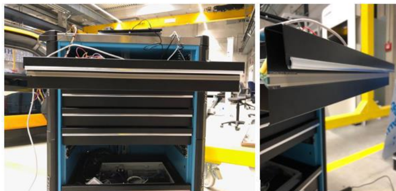
Ilustración 5: Sensor de presión en la parte frontal del cajón
