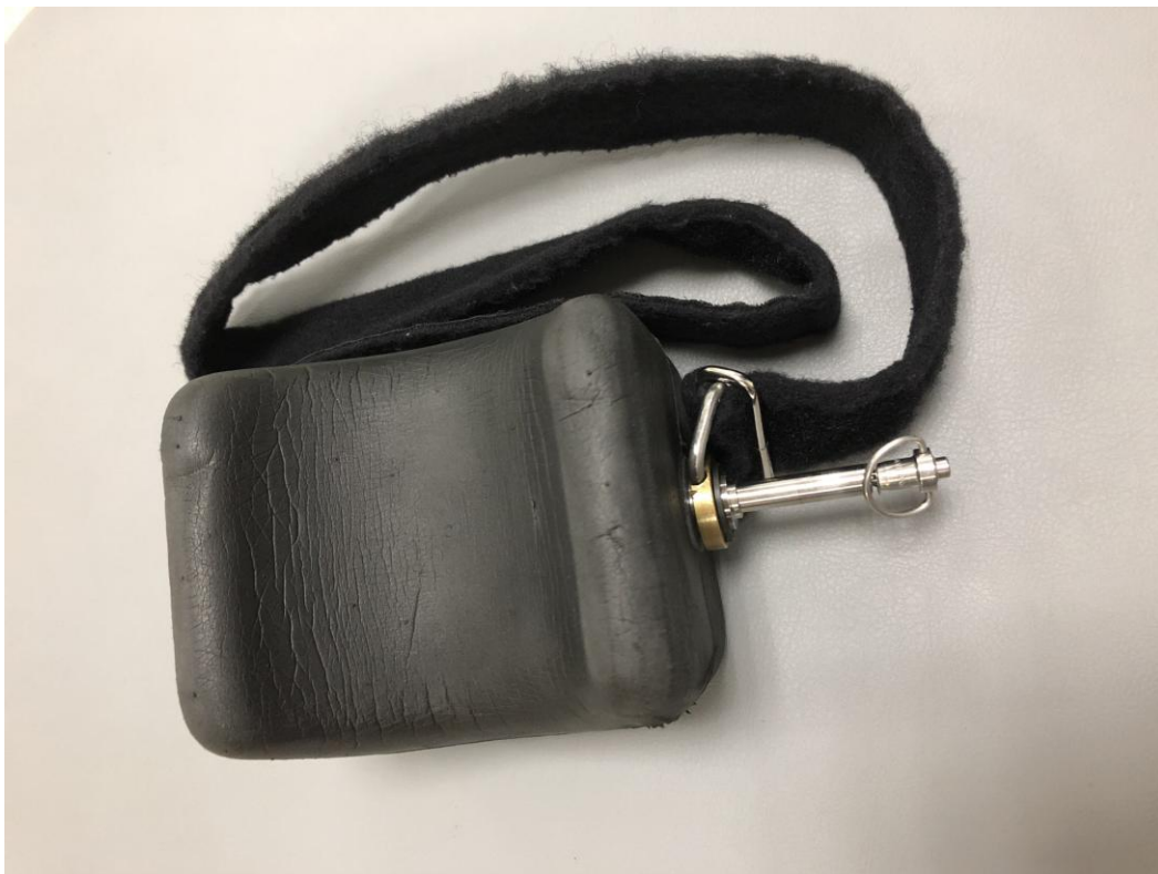
Figura 11. Herramienta de medición de dinamómetro isocinético. Sujeción tobillo. Elaboración propia
