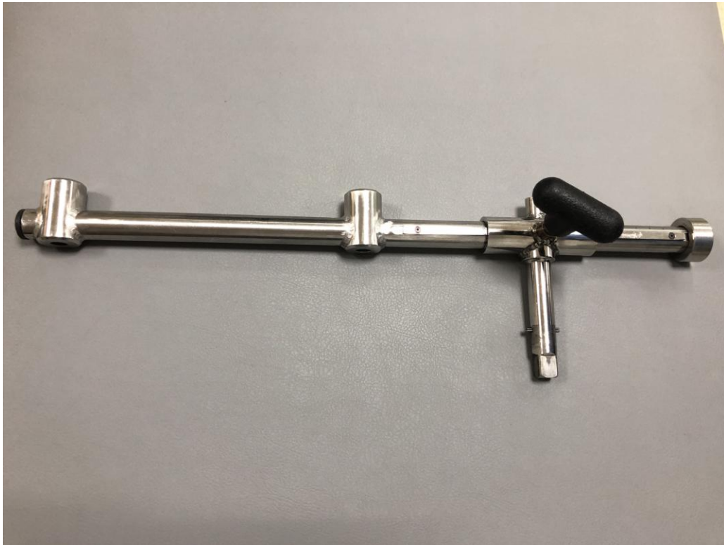
Figura 10. Herramienta de medición de dinamómetro isocinético. Herramienta 701. Elaboración propia
