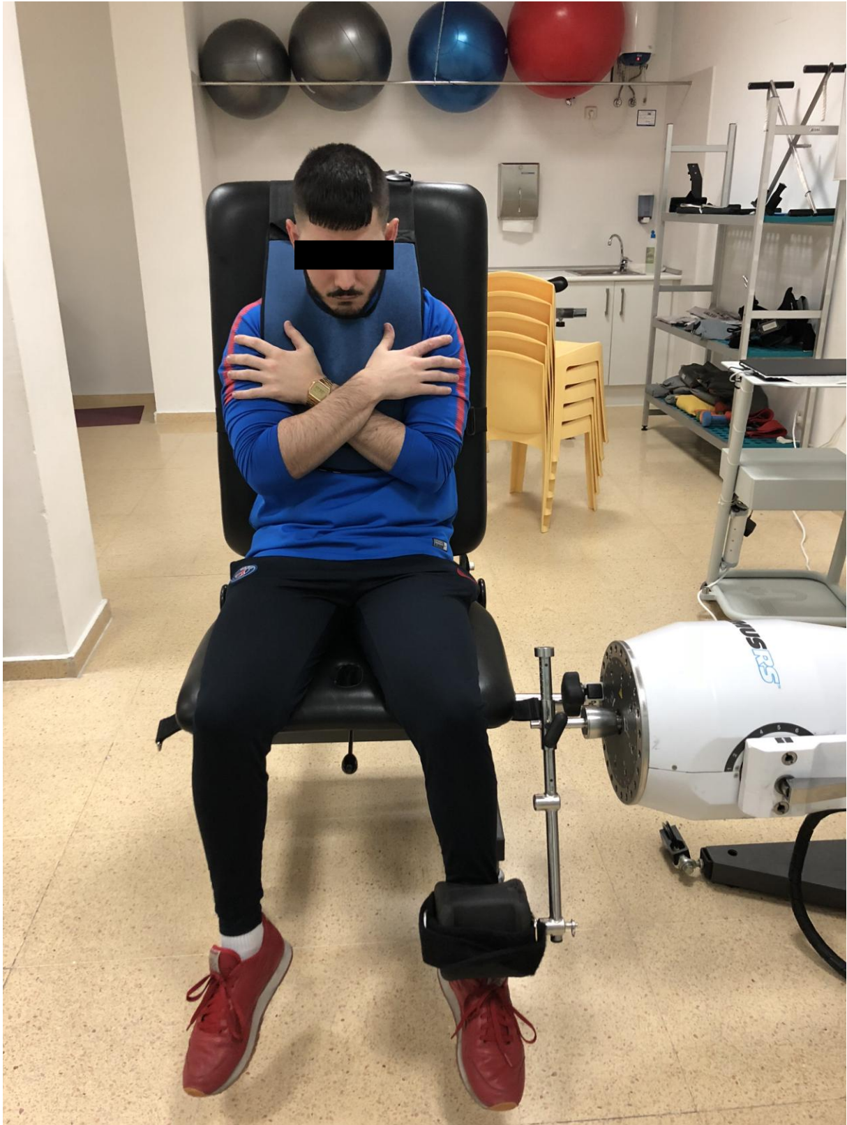
Figura 12. Cinchaje para medición en dinamómetro isocinético. Elaboración propia
