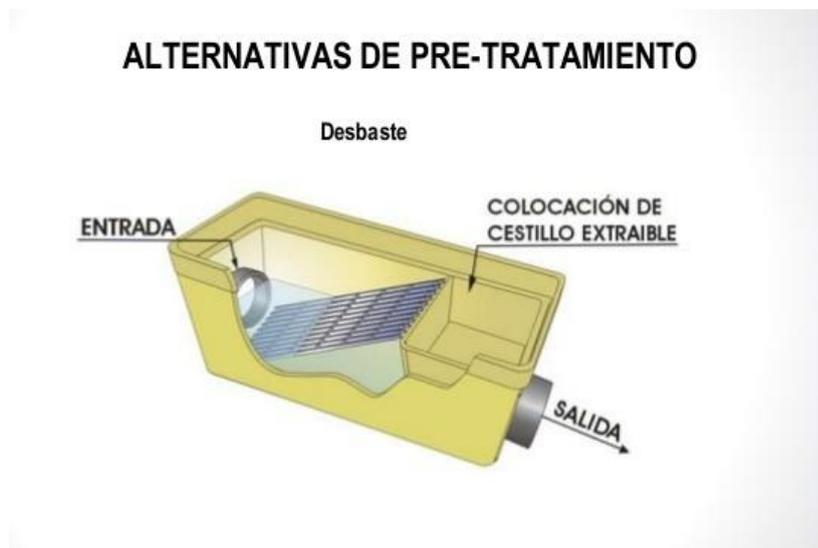
Ilustración 4: tratamiento de desbaste, fuente [www.slideshare.net/pretratamiento-de-aguas-residuales]
