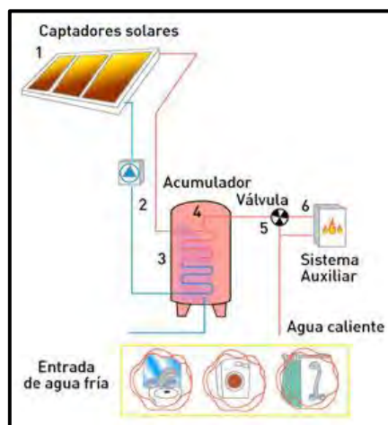
30 Funcionamiento de los paneles con tecnología solar térmica. Fuente: www.empresaeiciente.com
