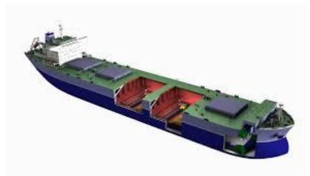
bodega, para no dificultar la descarga del mineral. Disponen en cubierta de grandes escotillas de carga (típicas de los bulk carriers) y un amplio sistema de tuberías y válvulas (típica de los petroleros)
