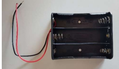
Figure 4: Contenedor de baterías original
