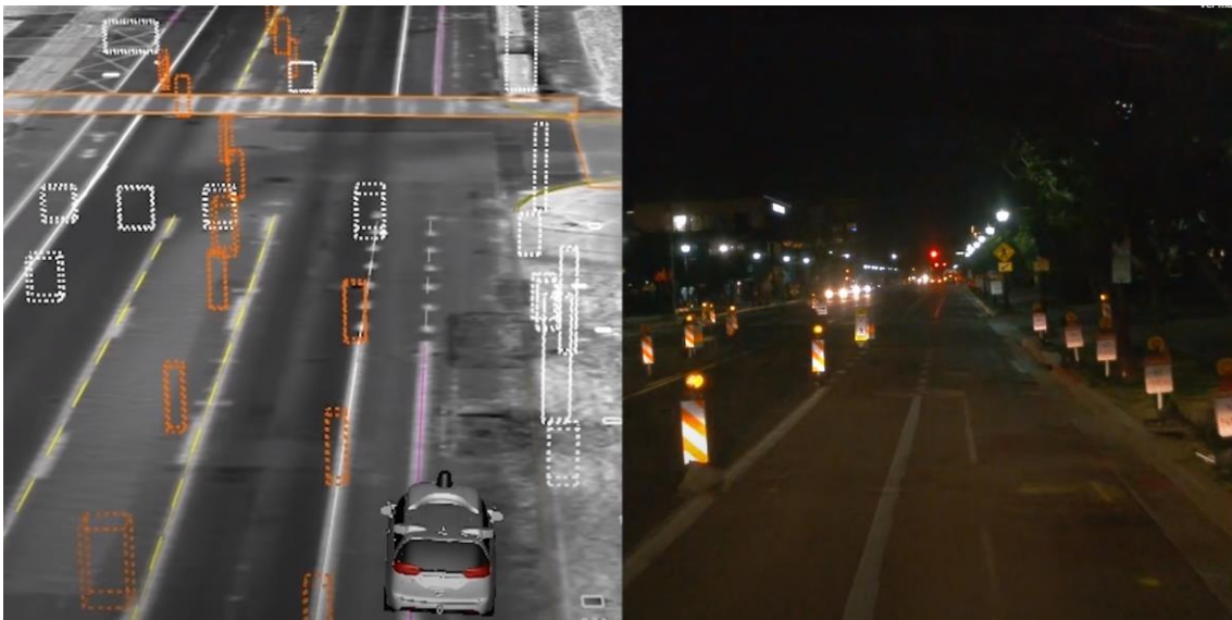
Ilustración 8. A la derecha, lo que se ve en la calzada; a la izquierda, el vehículo de Waymo y lo que está viendo en una zona de obras (Waymo, 2018).
