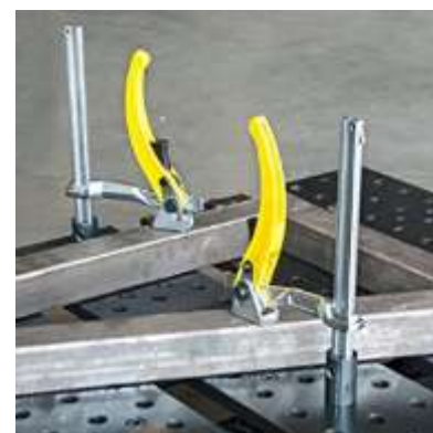
Ilustración 46: posición de las piezas en la mesa (derecha) y ejemplo de útil de sujeción (izquierda) imagen de Euroweld
