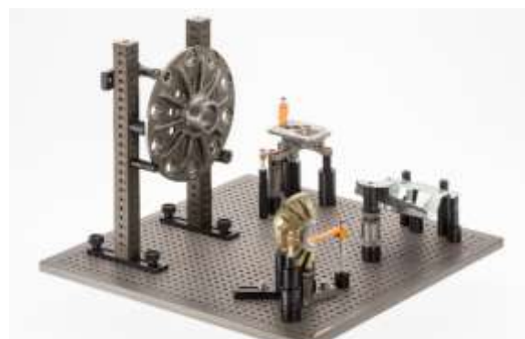
Ilustración 5: Ejemplos de sujeción de elementos mediante útiles de control. www.xyz-engineering.es , www.renishaw.es .
