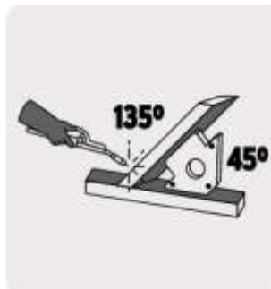
Ilustración 13: Posiciones de la escuadra magnética. Imagen obtenida de www.truper.com
