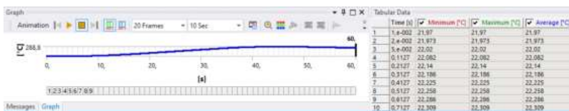
Ilustración 37: Registro de temperaturas en el nodo, solución en pantalla por ANSYS.
