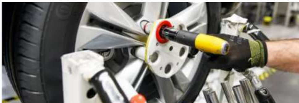
Ilustración 6: Útil de control para herramienta Volkswagen. www.ultimaker.com
