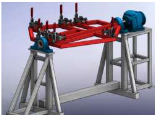
Ilustración 5: Ejemplos de sujeción de elementos mediante útiles de control. www.xyz-engineering.es , www.renishaw.es .
