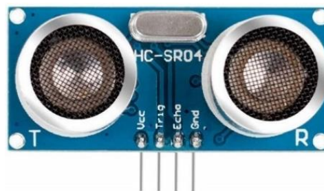
Ilustración 12. Sensor ultrasónico HC-SR04 [TIEN20]
