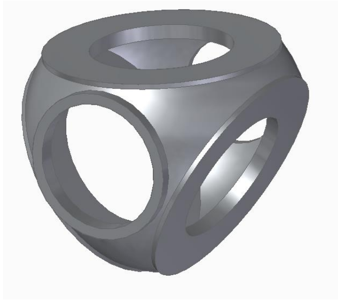
Figura 67. Modelo definitivo de buje realizado en Solid Edge
