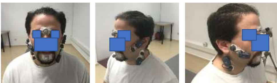
Imagen 7: Imagen propia. Posicionamiento de los electrodos de la electromiografía de superficie y de los marcadores del análisis de movimiento 3D
