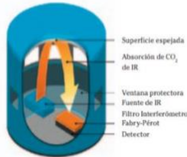
Figura 4 Detección de CO 2 por difusión
