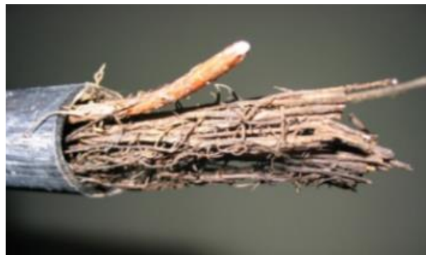
Ilustración 38 Obturaciones por raíces. Fuente: Azud
