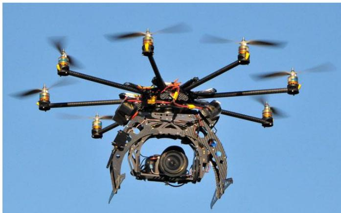
Figura 7: Dron multirrotor con cámara, de Personal-Drones, 2014<sup>7</sup>
