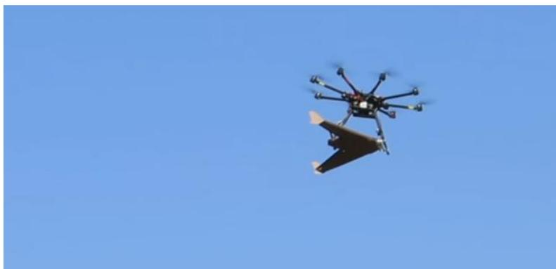
Figura 10: Dron multirrotor transportando el dron desechable APSARA para ser lanzado, de Gigazine 2017<sup>10</sup>
