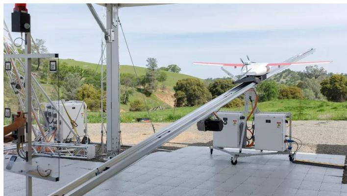
**Figura 5: Dron de ala fija en plataforma de lanzamiento, de: Stephen Shankland/CNET 2018<sup>5</sup>**
