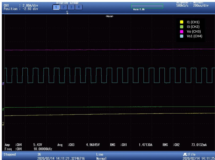
Figura 68: imagen del osciloscopio para una corriente de entrada  $I_1=1A$ , factor de servicio  $D=0,51$  y una tensión de salida  $V_o=5V$
