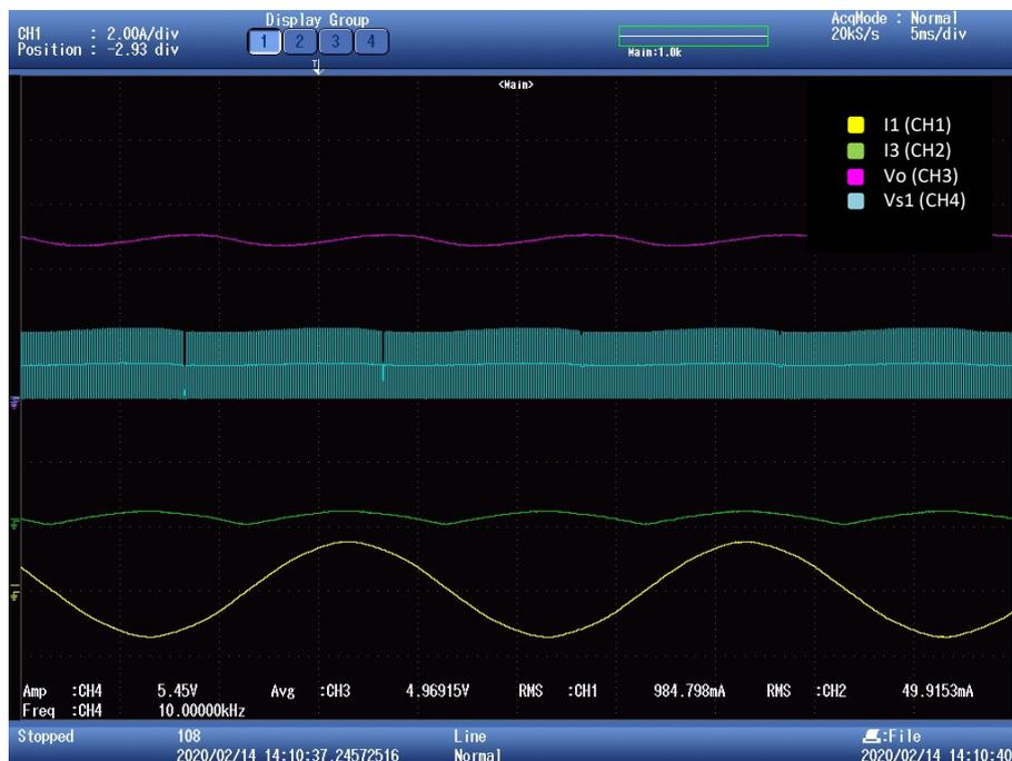
Figura 67: imagen del osciloscopio para una corriente de entrada  $I_1=1A$ , factor de servicio  $D=0,51$  y una tensión de salida  $V_o=5V$
