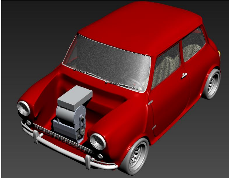
Ilustración 86: Modelo aproximado 3D MINI 1275 GT con motor eléctrico e inversor acoplados a la caja de cambio. Modelo CAD Mini obtenido de GrabCad, sistema de tracción diseñado para este TFG
