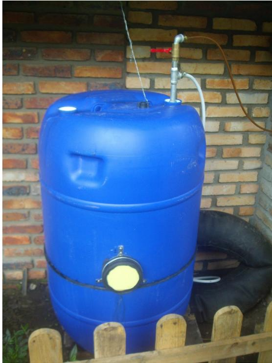
*Figura 5.1. Diseño 1 propuesto para un biodigestor (sin enterrar)*
