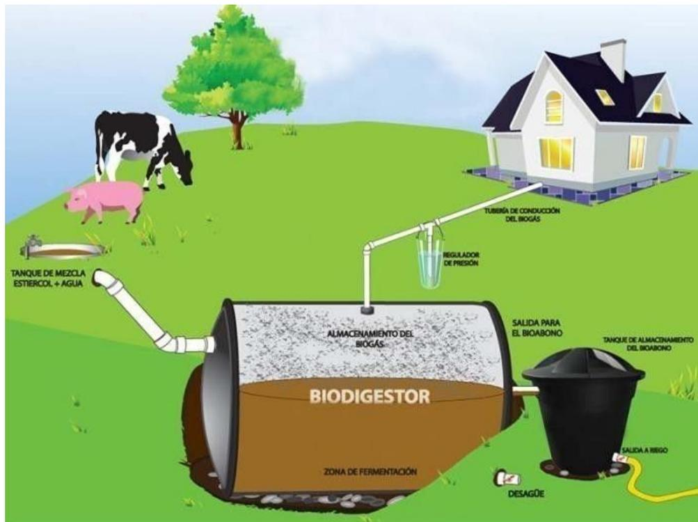
Figura 4.9. Esquema de un biodigestor
