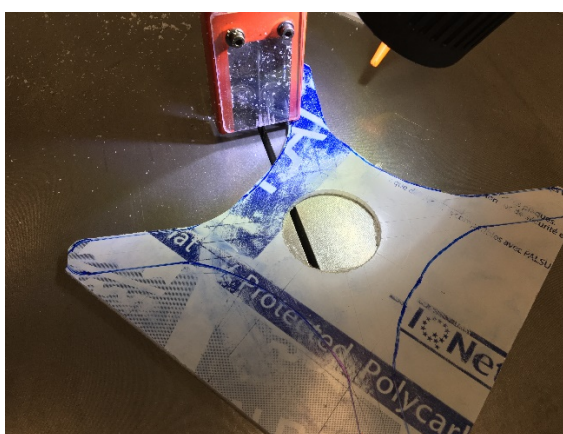
Figura 48 Proceso de recorte del contorno del soporte superior
