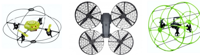
Figura 51 Posibles soluciones de protecciones a implementar
