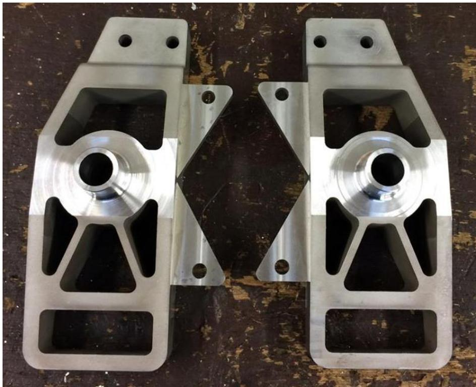
*Figura 5: Manguetas fabricadas*
