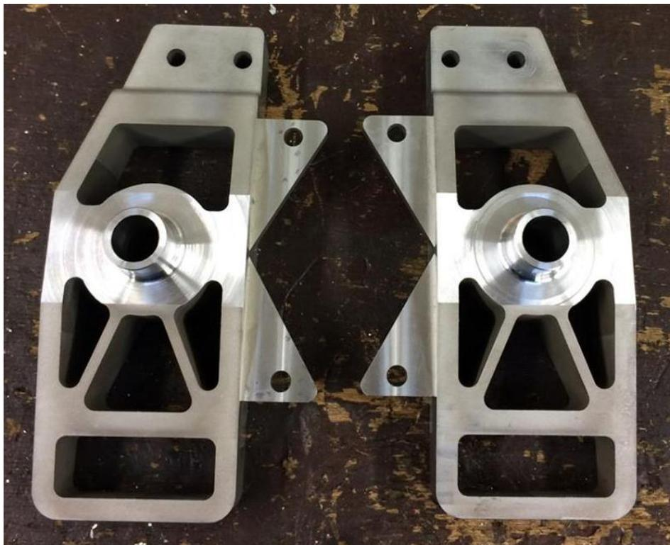
*Figura 37: Fotografía de las manguetas delanteras ya fabricadas*
