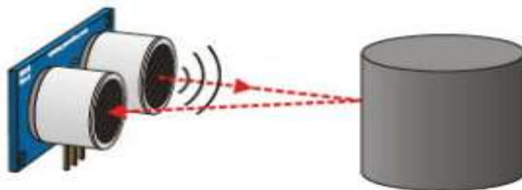
Figure 3: Esquema del funcionamiento de la ecolocalización
