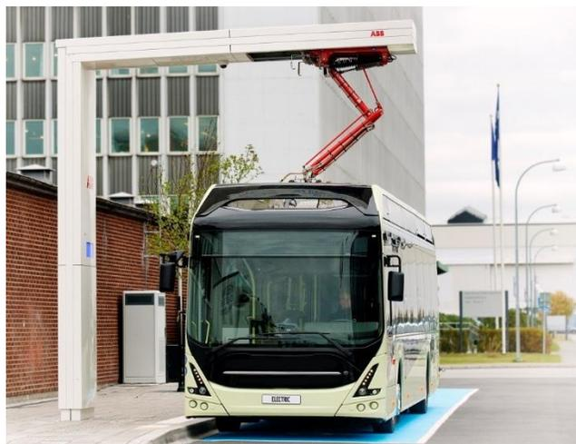
*Ilustración 4: Recarga de un autobús eléctrico mediante pantógrafo*
